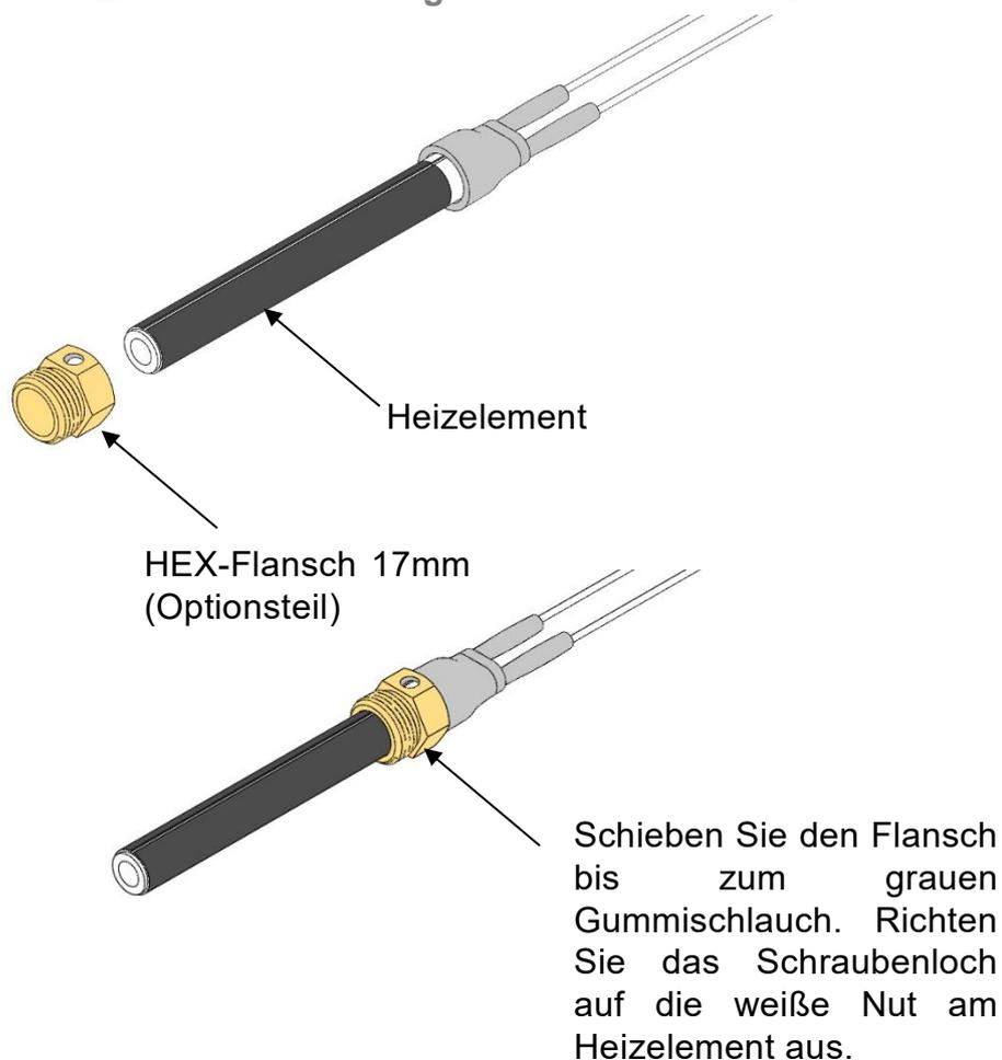
b) Schrauben Sie die M4-Befestigungsschraube fest, um den Flansch zu befestigen.
