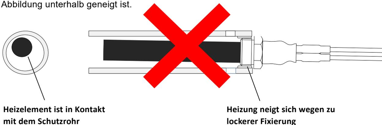
Bitte stellen Sie sicher, dass um das Keramikheizelement und das Rohr ein Zwischenraum von mind. 3 mm vorhanden ist.
