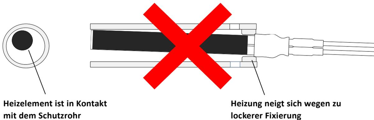
Bitte stellen Sie sicher, dass um das Keramikhezelement und das Rohr ein Zwischenraum von mind. 3 mm vorhanden ist.
