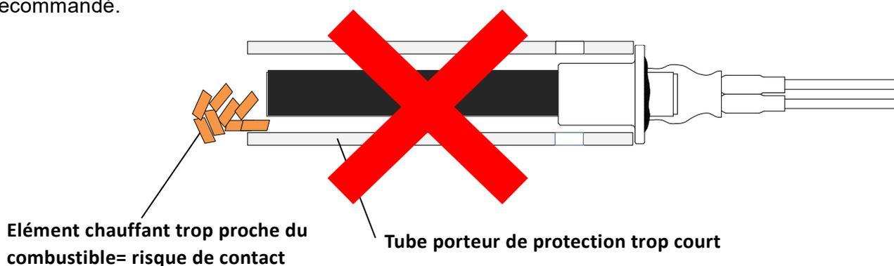
Le système de fixation doit être envisagé pour éviter la situation suivante.
